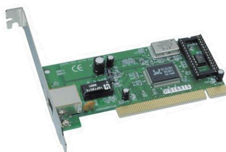
Рис. 13. Сетевая карта Comrex RE100TX PCI 10/100
